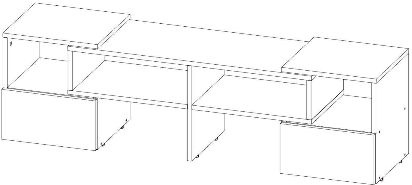
Максимально допустимая нагрузка на направляющие – до 5 кг при условии равномерно распределенной нагрузки.
