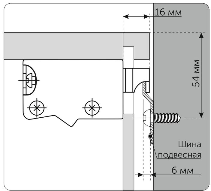
Регулировка положения шкафа при помощи винтов на креплениях «краб»
