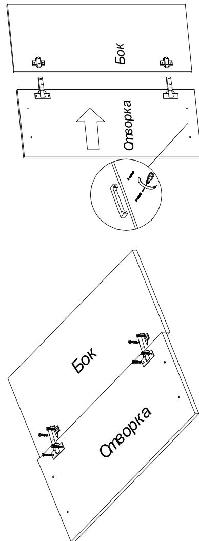
Крепить петли шурупами 3,5x15 мм к фасаду. Затем приложить торец фасада с прикрученными петлями к торцу боковины шкафа и крепить ответные планки петель к боковине шурупами 3,5x15 мм. Открутить винт на петле ("регулировка по глубине") и разъединить бок шкафа и створку.
